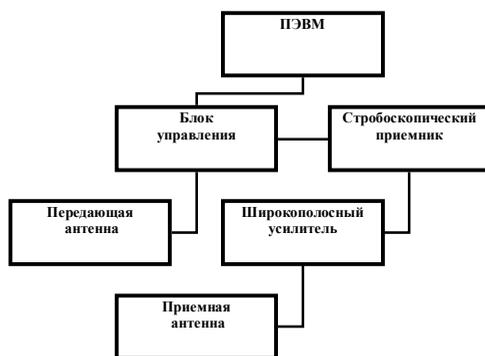
Рис.2.2 Блок-схема георадара импульсного типа
