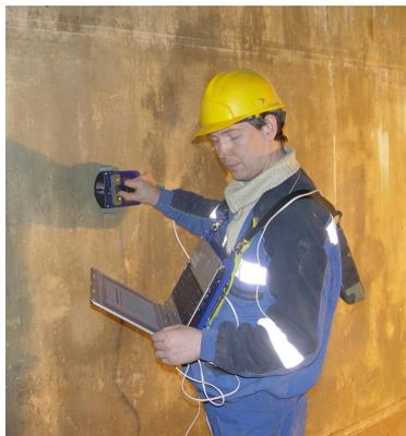
Рис.4.3 Рабочие моменты проведения георадиолокационного обследования железобетонных стен
