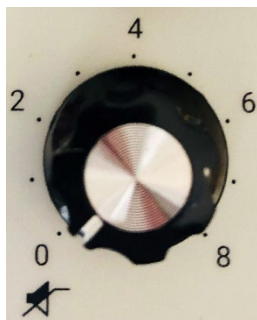
Рисунок 7 Регулятор уровня срабатывания звуковой индикации прибора
