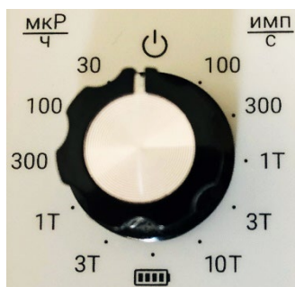
Рисунок 5 Переключатель выбора масштаба шкал и режима измерения
