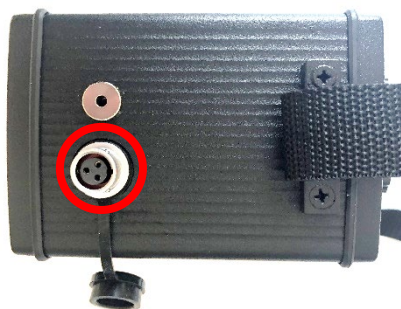
Рисунок 8 Разъём для подключения блока детектирования и зарядного устройства
