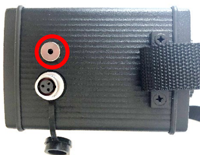
Рисунок 14 Разъём для подключения наушников на корпусе пульта
