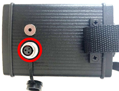
Рисунок 12 Разъём для подключения блока детектирования на корпусе пульта
