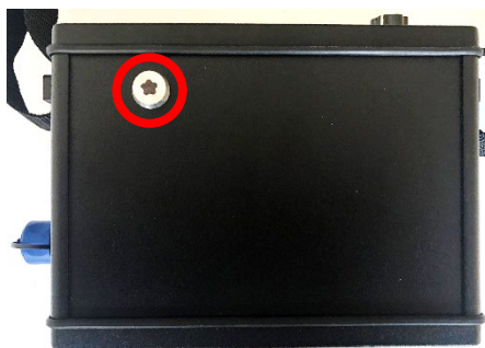
Рисунок 11 Заглушка потенциометра установки масштаба шкал при измерении мощности экспозиционной дозы
