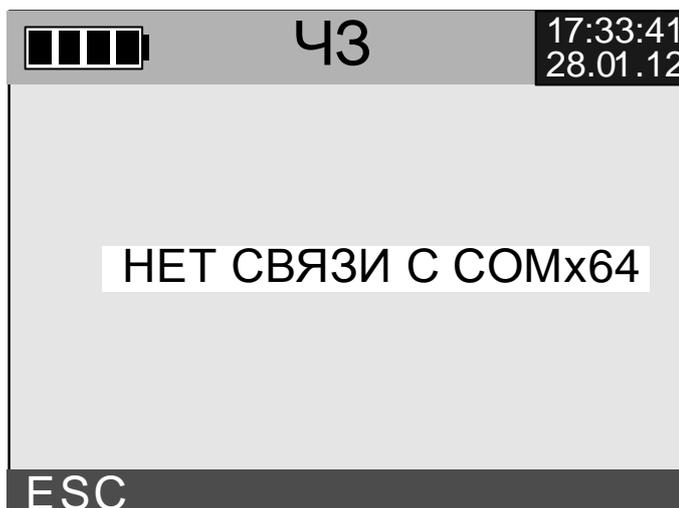
Рис.7.5. Экран ошибки связи с коммутатором
