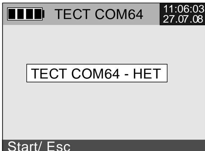
Рис. 3.4. МЕНЮ ПРОВЕРКИ ПОДКЛЮЧЕНИЯ БЛОКА-КОММУТАТОРА COMx64
