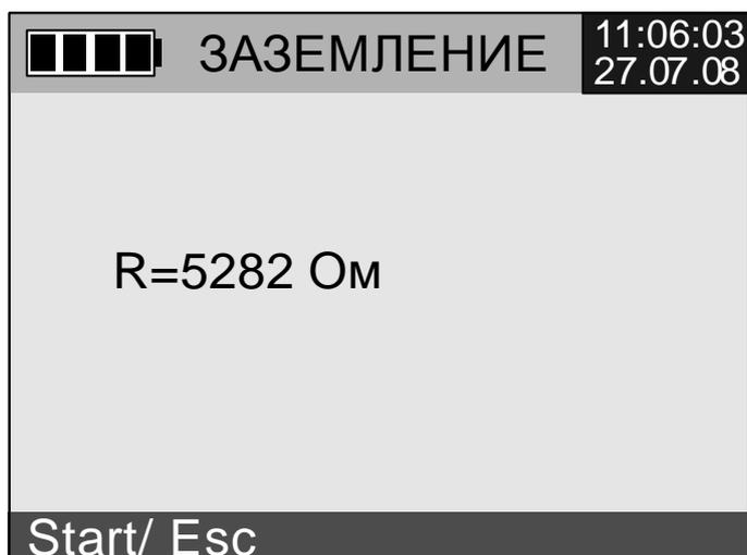
Рис. 3.3. МЕНЮ ИЗМЕРЕНИЯ СОПРОТИВЛЕНИЯ ЗАЗЕМЛЕНИЯ
