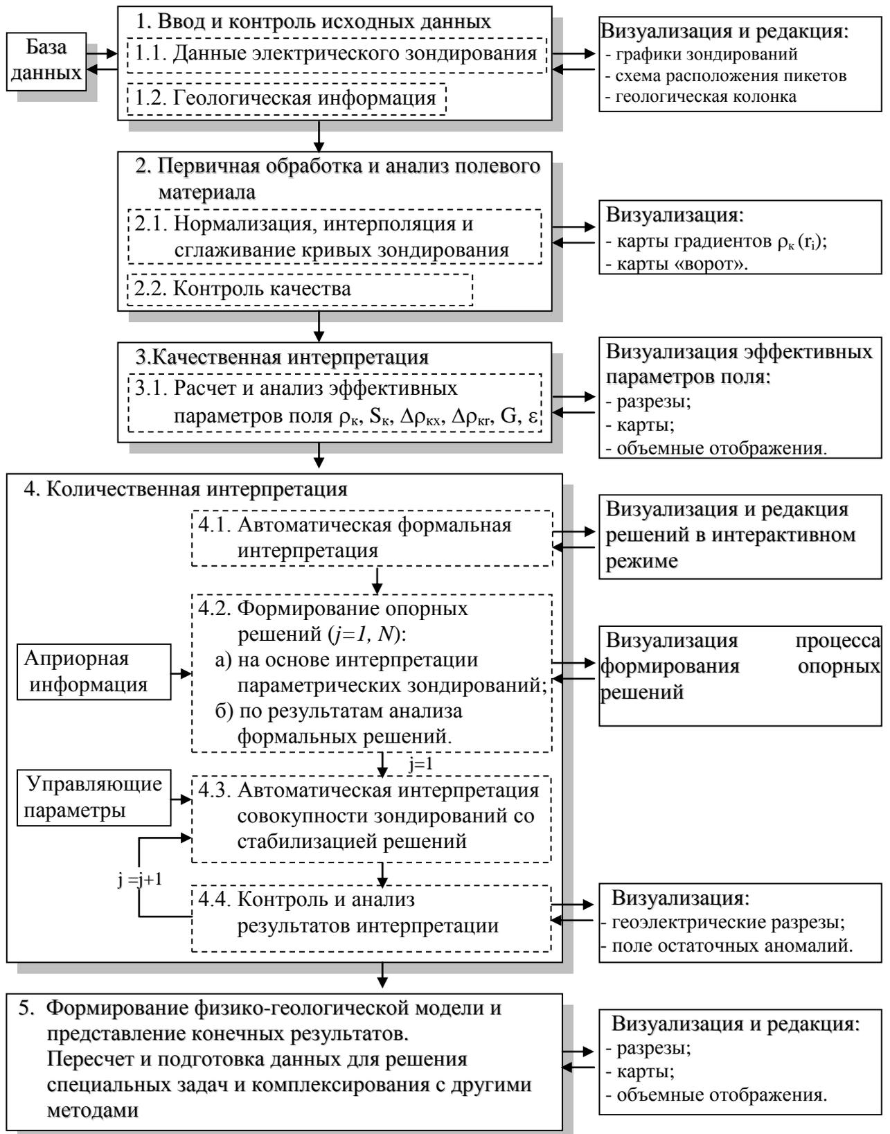
Рис. 1.1 Технологическая схема обработки и интерпретации электрических зондирования с помощью автоматизированной системы ЗОНД
