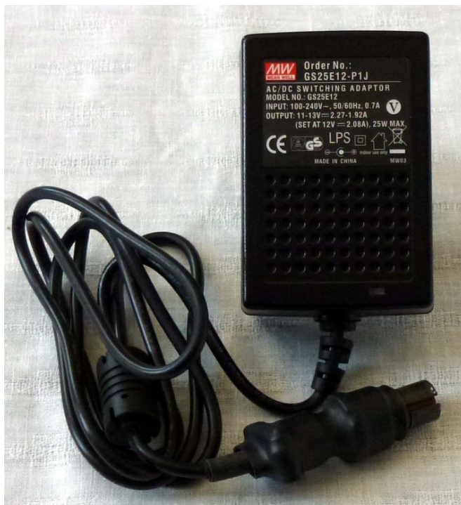
Рис. 4. Блок питания сетевой «IN: 220V 50 Hz, OUT: 12 V, 2.0 A».
