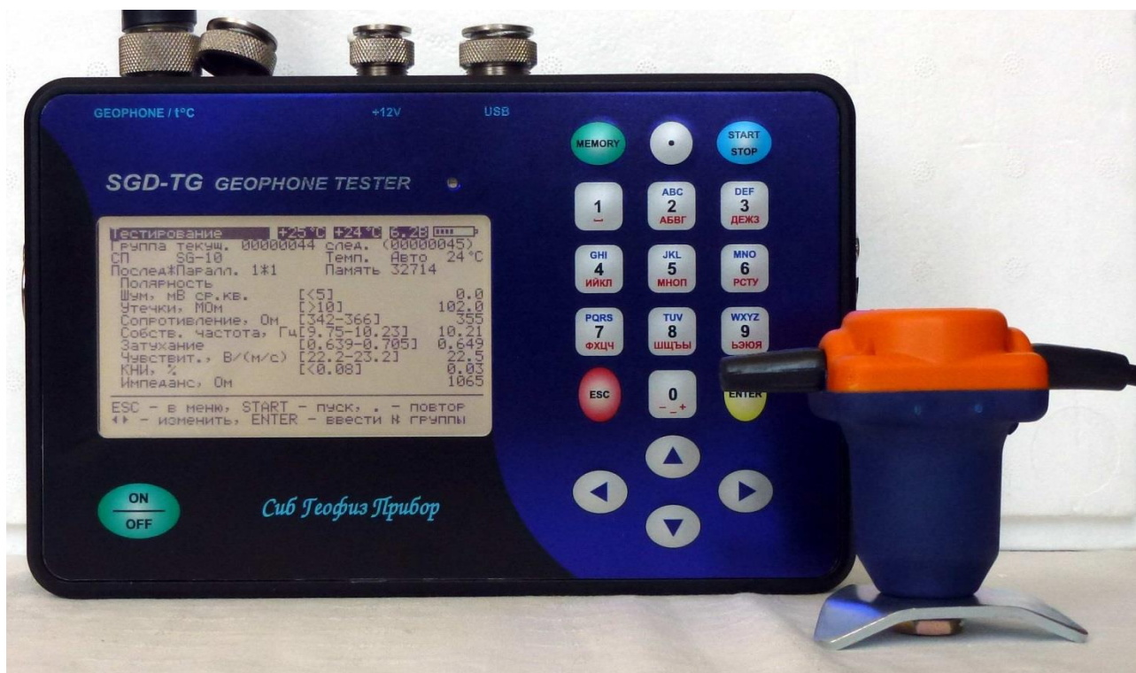
Рис. 1. Тестер геофонов SGD-TG . Результат тестирования геофона SG-10 (Sercel).
